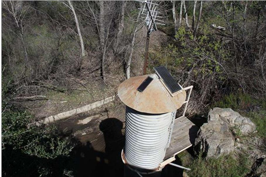
**Fotografía Nro. 4.4. Estación de hidrométrica del USGS en la intersección de la quebrada Campo con la ruta estatal Nro. 94.**
